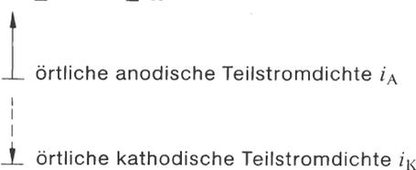
Bild 3. Teilstromdichte-Verteilung bei der Mischelektrode für freie Korrosion
